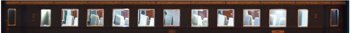
Für N-Personenwagen bietet LILIPUT eine LED-Innenbeleuchtung an, die mit vier Radkontakten, vier Kontaktbügeln und mit Flackerschutz durch einen eingebauten Kondensator ausgestattet ist. Die gelben LEDs geben ein vorbildgerechtes Glühlampenlicht (vorwiegend für Wagen der Epochen II bis III), die weißen LEDs geben ein vorbildgerechtes Neonlampenlicht (vorwiegend für Wagen der Epochen IV bis VI) wieder.
